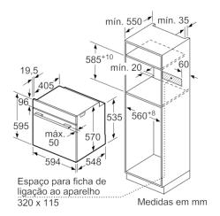
Instalação com uma placa de cozinhar.
