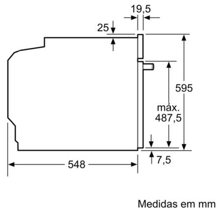
Instalação com uma placa de cozinhar.
